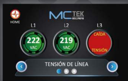
Registro de caídas de fase
